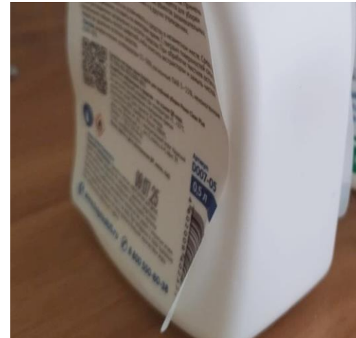
Воздействие агрессивного растворителя на каучуковый клей
